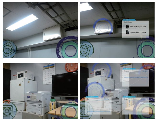
図 12 電力情報可視化システム動作画面：認識前 (左)，認識後の AR 表示 (右)
