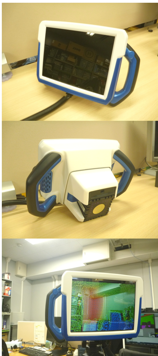
図 13 AR スコープ: 表側 (上), 裏側 (中央), 動作例 (下)
