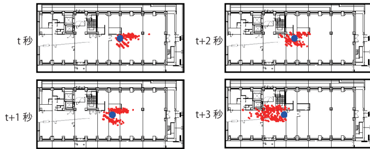
図 2 Particle Filter による位置推定結果の提示 Fig. 2 Visualization of the location estimation using particle filter.
