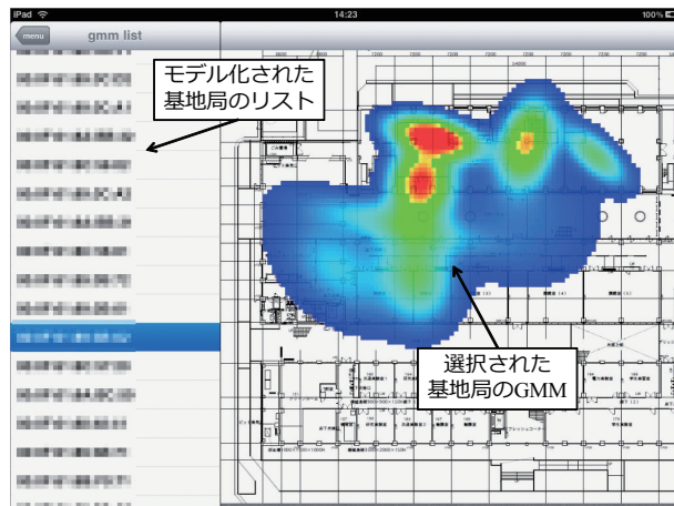
図 9 GMM によりモデル化された無線 LAN 情報 Fig.9 WLAN information model using GMM.
