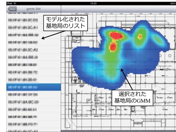
図 7 GMM によりモデル化された無線 LAN 情報 Fig.7 WLAN information model using GMM.
