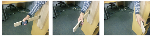
図 8 腕の回転運動（重力加速度の影響を受けない場合） Fig.8 Rotation(No effect of gravitational acceleration)
