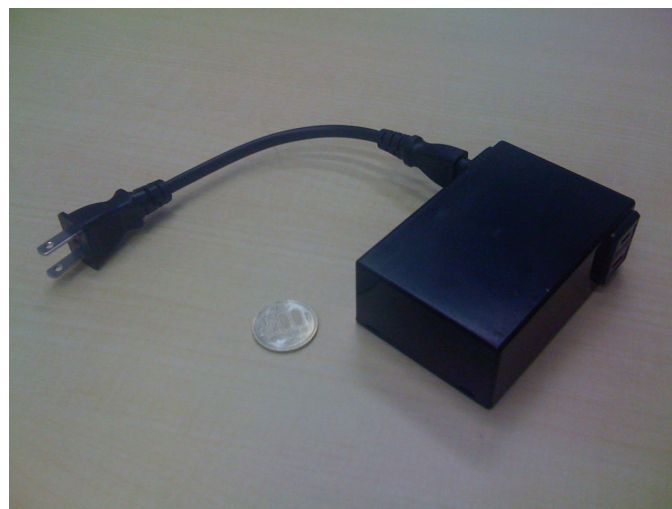
図5 細粒度計測電力センサ Fig. 5. Fine-Grained Watt Meter
