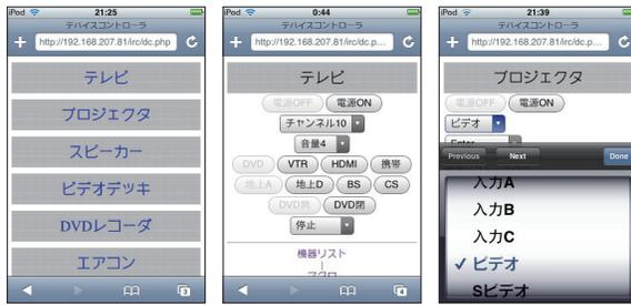
図 19 携帯端末からの機器制御を可能にする Web アプリケーション
