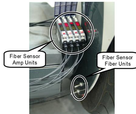
図 9 光ファイバセンサによるタイヤの回転量と回転方向の計測
