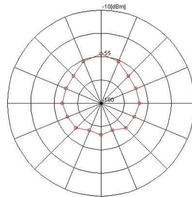
図 13 指向性アンテナの電波強度分布 (16m)
