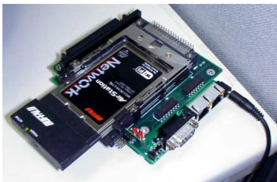
図 5: 組み込み PC モジュール (LAMB-EM-01)
