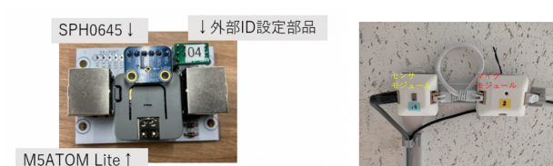
図 2 マイクモジュールと設置図
