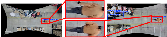
図 6: 画面上の位置と移動方向が近い検出結果の例
