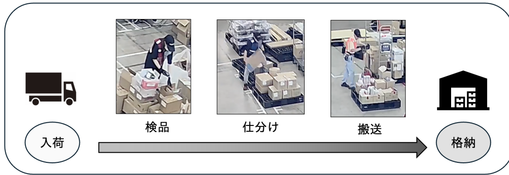
図 1: 物流倉庫における荷物入荷から格納までの流れ
